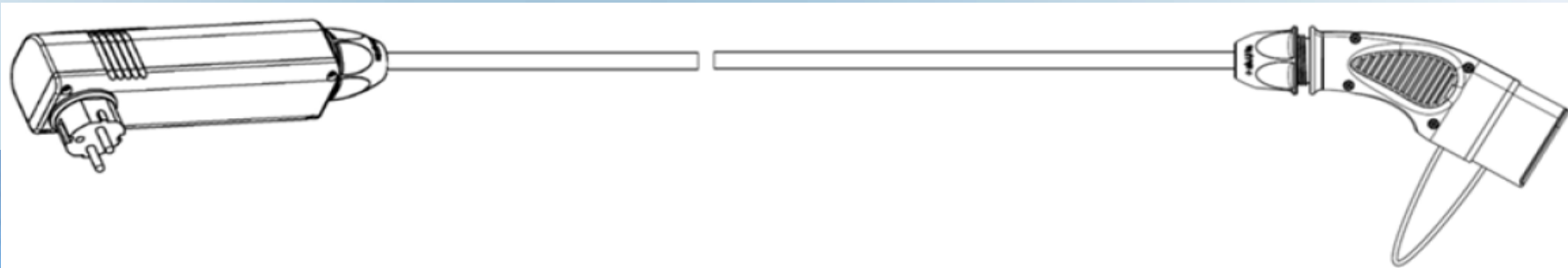
그림 F.2 — 4.2.3에 따르는 플러그 통합 기능 박스의 예
