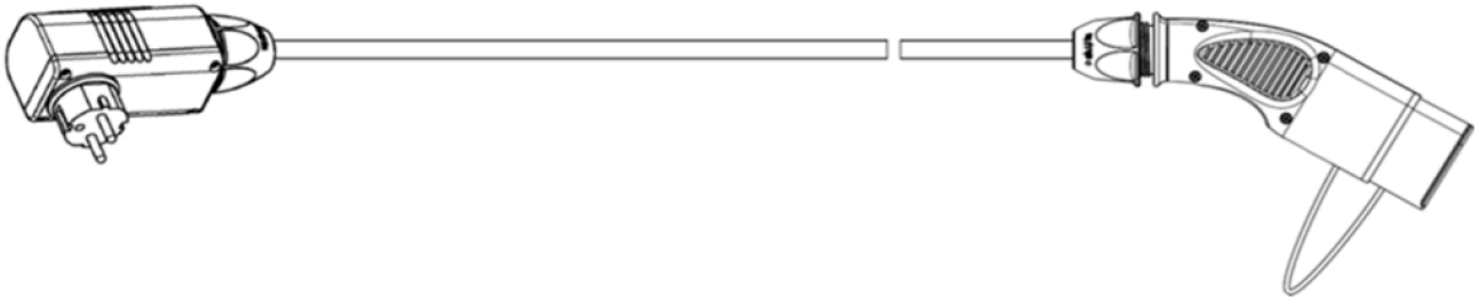
그림 F.4 — 4.2.4 b)에 따르는 모듈식 IC-CPD의 예
