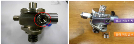
(B) 체결부 파손 - 밸브
