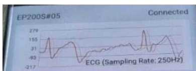
Photo. 1 스티어링 휠에 적용 가능한 전도체를 활용한 ECG 출력값
