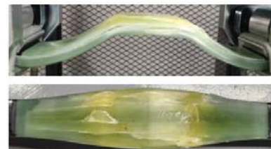
✓ Fig. 4 제품 제조 불량 (Resin-Rich 현상)
